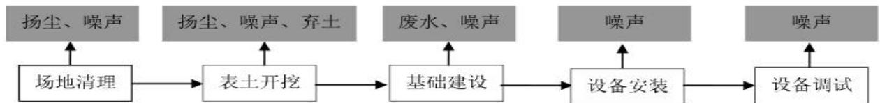
图4 施工期工艺流程及产污环节
